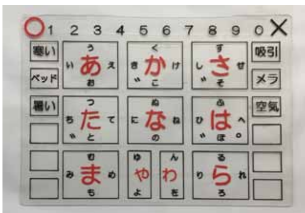
「訴え欄付きフリック文字盤」 目標枠を大きくすることで眼球運動の低下に対応できる、また支援者側も読み取りやすい
