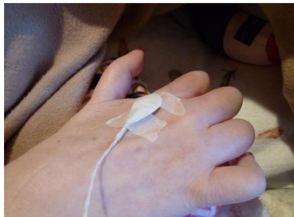
ピエゾ・センサーを示指の屈曲動作で腱が変化する部位に紙テープで装着する方法は、効率的に感知する部位の特定や装着の仕方に経験を要するだけでなく、不確実な状況となることが多い(図 10)。
