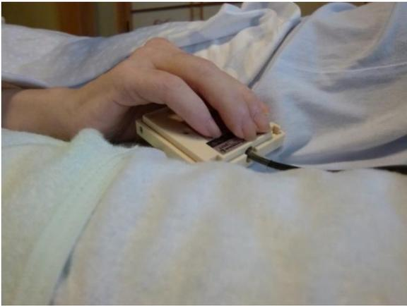
手押しボタンスイッチは反応する場所にクセがあるので押す動作に応じて、握り込む方向に注意する必要があります。
