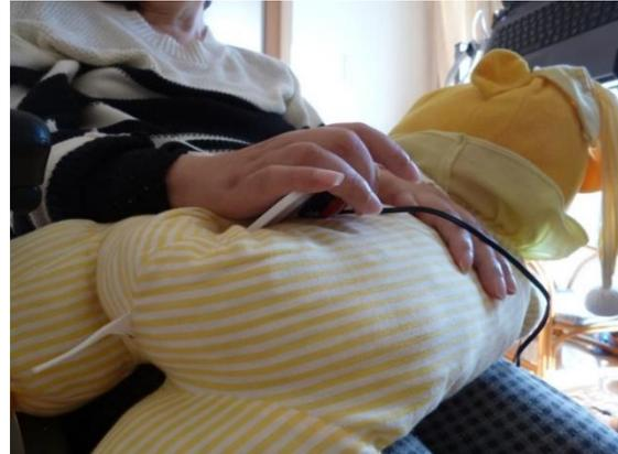
握り込む動作が優位であることから、スペックスイッチを中指の屈曲動作で操作できるように板状の素材に貼り付け、意思伝達装置の試行評価を行なった(図 3-1)。
