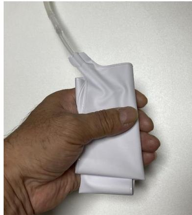
エアバッグは折りたたんでも使うことができます。この場合、チューブ接続部を表側にします。内側に入ると動きを読み取れず、反応が悪くなる場合があります。
