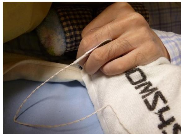
ピエゾ・センサー全体を貼り付ける不適切な接着方法(図 13-1)だけでなく、環指の動作を的確に感知する手背部への設置も不確実性が生じる状態にあった。
