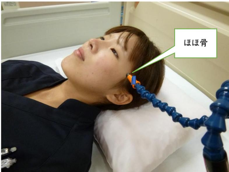
センサー部に露出した皮膚が触れることで人の静電気を感知する仕様ですが、爪や髪の毛、髭、衣服などでは反応しません。
