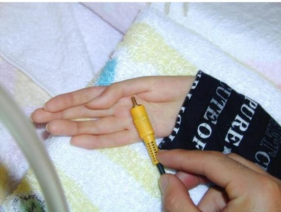
正確な母指の内転動作に直交する状態のセンサー一部の接触箇所は基節骨であり、ピンタッチスイッチの設置方向は的確な状態にはなく、RCA ケーブルに変更するなど必要であった。適切な操作部位と設置箇所は(図 27-3)のようになる。
