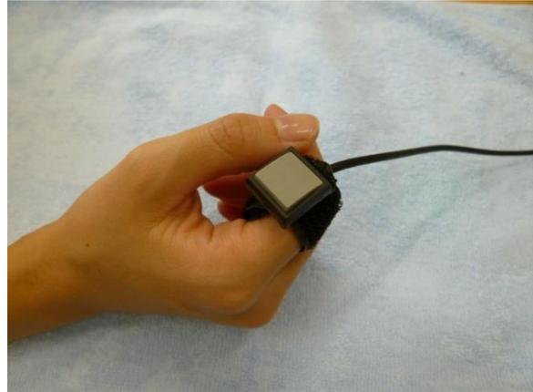
示指に開始当初の位置(図 4-1)に装着しても、時間経過に伴いサイドピンチの運動方向の変化(図 4-2)が生じることにより操作スイッチの場所ではないところを押し込んだ操作不能な状態に陥ってしまう。
