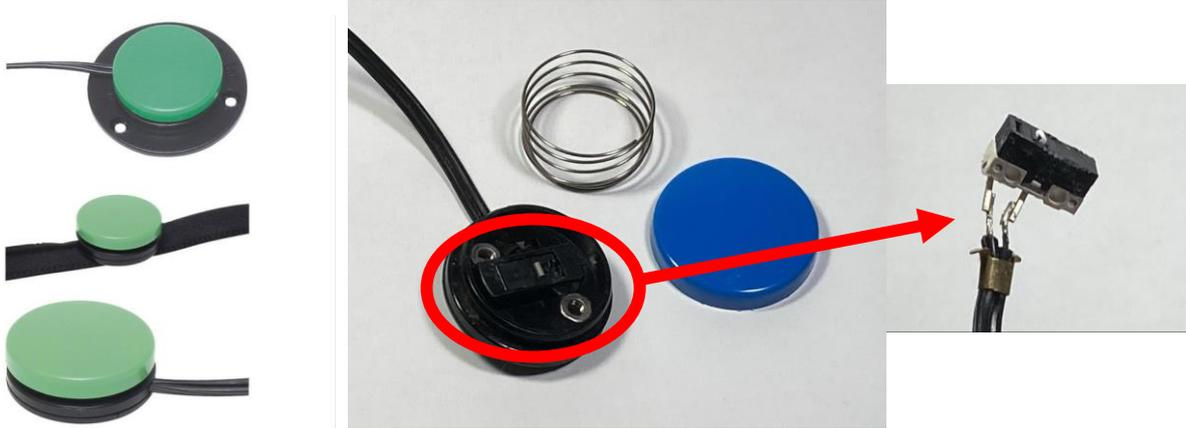
スイッチは押すばかりでなく、ひもを引くタイプのストリングスイッチもあります。ストリングスイッチにもマイクロスイッチが使われています。
