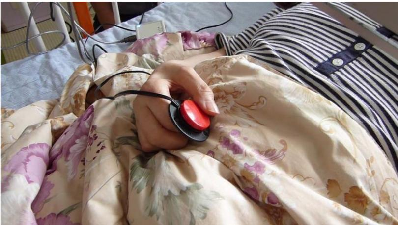
テレビやエアコンなどのリモコンボタンを押せる筋力があっても操作スイッチを押込むまでの空間が不適切であると、押込むまでの余分な動作を強いることになり、意思伝達装置の文字選択など操作に必要以上の集中力を要する状態になります。
