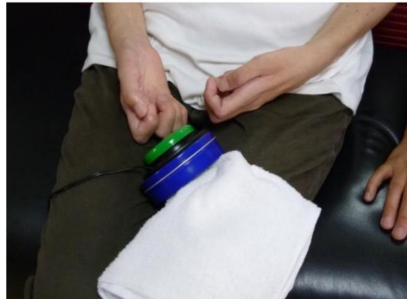
ジェリービンスイッチを手背部で押す操作で意思伝達装置の試行時選択操作の遅れや誤選択が見受けられた。これは腕の振り下ろしによる操作が優位な動作ではないことが原因であった(図 6-1)。
