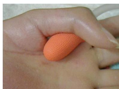
吸引カテーテルの先端を熱密着したものは、口にくわえる噛むスイッチとして使われています。
