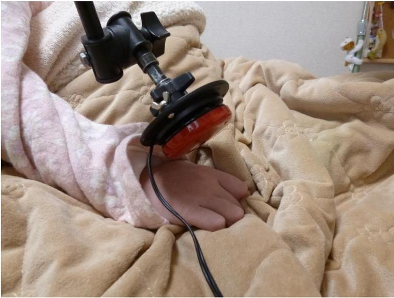
手首の動きでジェリービンスイッチを叩く操作で意思伝達装置を使用していたが、再評価を求められ、強い不随意運動はあるが初動が背屈動作であることから入手済みのスタンダードアームによる固定設置に変更し、優位な動作によるスイッチの操作に変更している。
