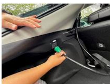
停電時プリウスに接続（赤コンセントに電力がつながる）
