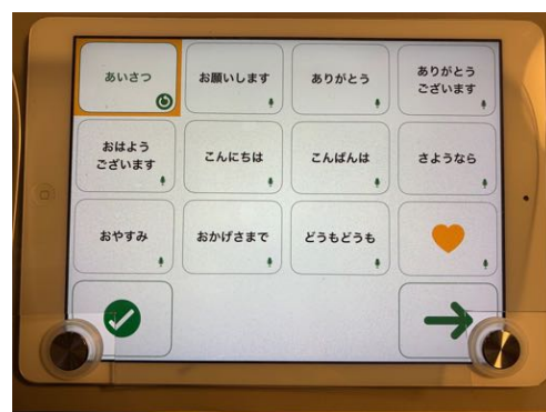
厚手の透明ビニールシートに、項目選択と決定の2箇所（画面左右下）だけ穴を開け他は触っても操作できないようにした。
