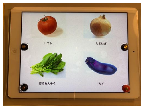
1画面に4枚のカードを表示した画面を選ぶように、4箇所だけ穴を開け、そこに吸盤式のボタンをおいた。
